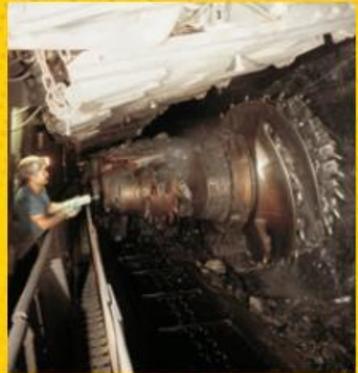
▲ Extraction en plateures, avec la méthode des longues tailles au pendage foudroyées.
